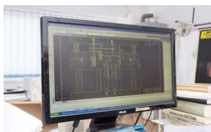
Detaliu secțiune, într-un proiect de matriță
